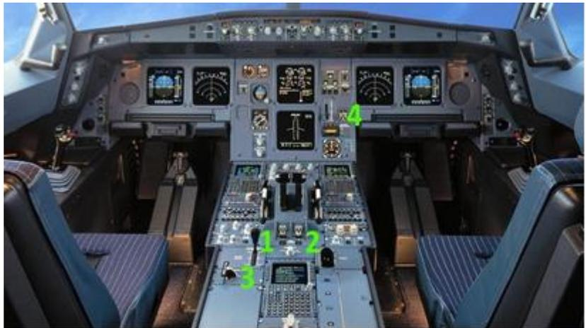
(4) *El freno de mano debe estar puesto para la inspección exterior para revisar los indicadores de desgaste de los frenos.*
